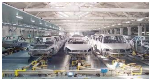
例) 塗装搬送ライン
